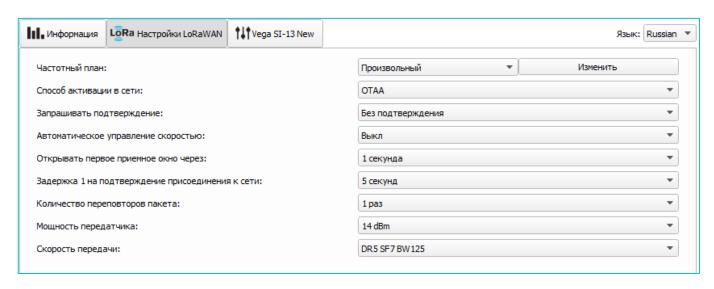
**Частотный план** – позволяет выбрать один из частотных планов, имеющихся на устройстве или задать *произвольный* частотный план. Произвольный частотный план функционирует на базе частотного плана EU-868.
