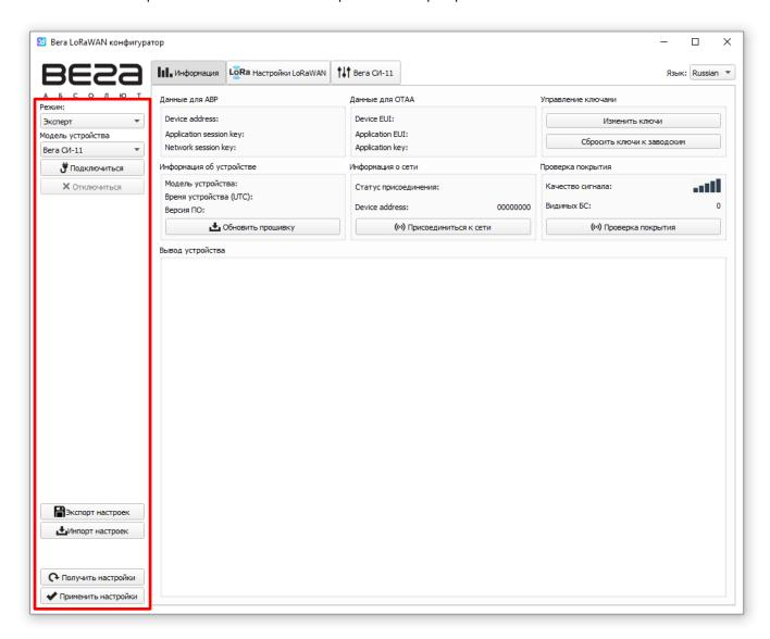
Меню слева позволяет переключаться между режимами работы программы «Простой» и «Эксперт», выбирать модель устройства, осуществлять подключение к устройству или отключиться от него.
