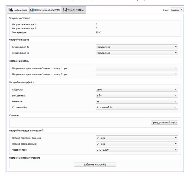
**Текущее состояние** – отображает текущие параметры устройства – количество подсчитанных импульсов на входах и температуру.
